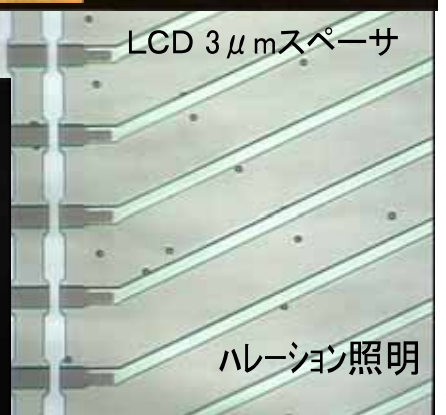
携帯電話タッチスイッチの腐蝕
