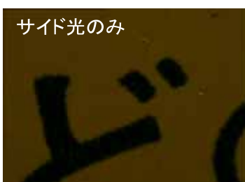
ワークを傾斜し反射を撮る
